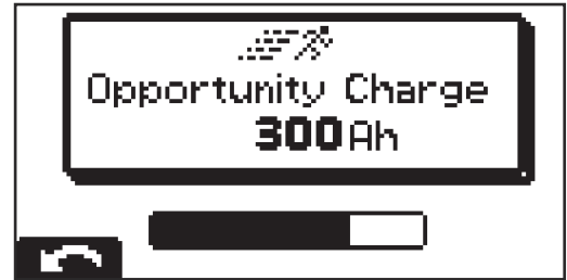
Anzeige bei Start der Zwischenladung
